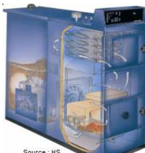
Chaudière semi-automatique (multi combustibles)
